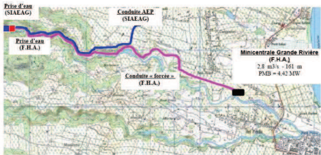
Figure 4-5 : Synoptique des installations sur la Grande Rivière Capesterre
